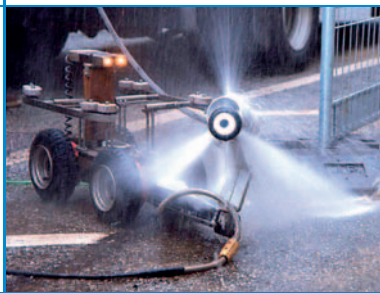
Satellitenkamera auf Spülschlauchbasis
