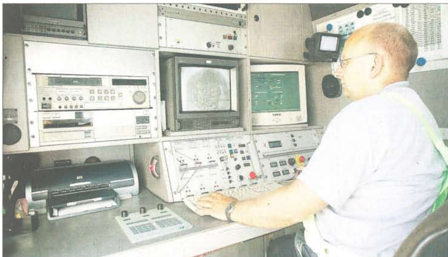
Tiefe Einblicke in den Untergrund: Während die Kamera durch die Abwasserschächte fährt, überwacht TV-Operator Jörg Liebergeld von der Firma tkm die Aktion an den Bildschirmen. Foto: privat/nh
